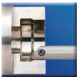
内孔车削及越程槽
